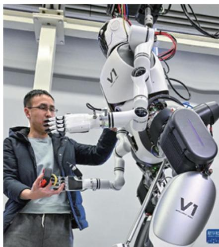
图3 中国科学院自动化研究所人形机器人攻关团队科研人员在多模态人工智能系统全国重点实验室调试机器人。新华社发
