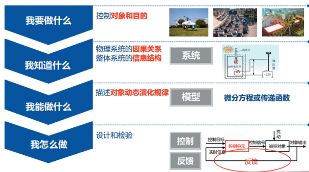
图4 自动控制系统设计的基本步骤
