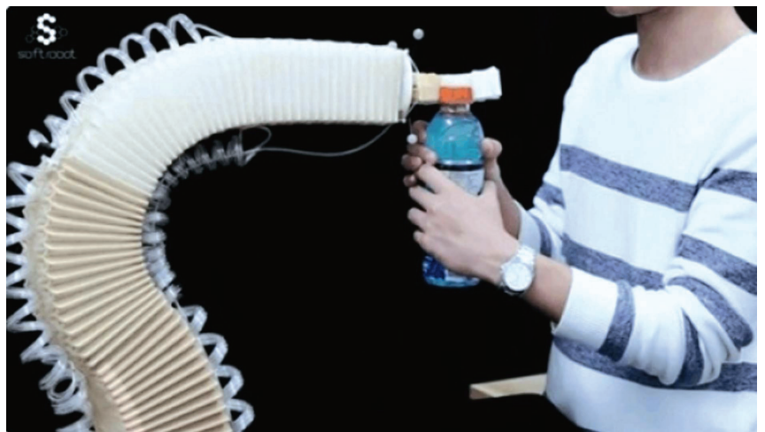
图1 中国科大机器人团队研发出一种可拧开瓶盖的机器人手臂
