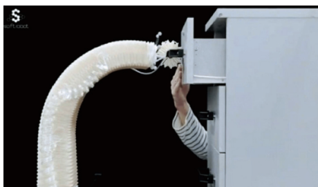
图3 机器人柔性手臂在干扰下完成任务
