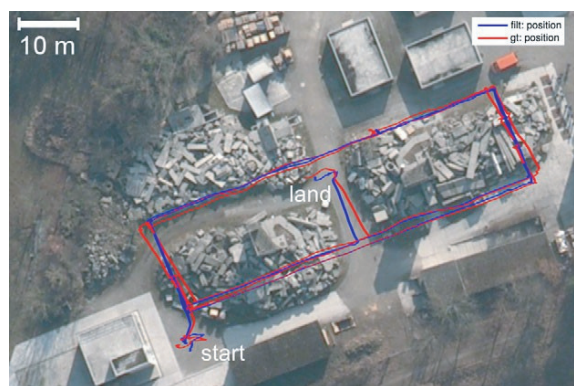
图9 瑞士苏黎世联邦工学院四旋翼无人机长距离飞行实验图
