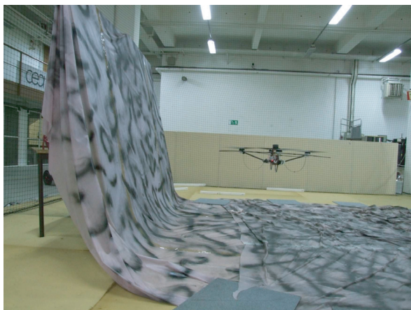
图5 澳大利亚国立大学基于光流的无人机室内控制实验
