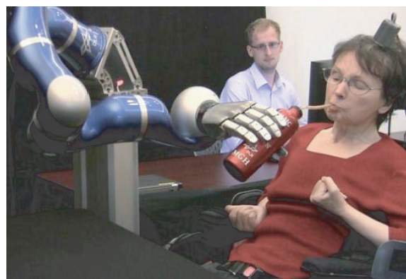
图5 一位58岁的中风患者，已瘫痪15年，经过训练用自己的思想来控制机械手臂，抓住一瓶咖啡，给自己倒水，并放回桌子上 [26]
