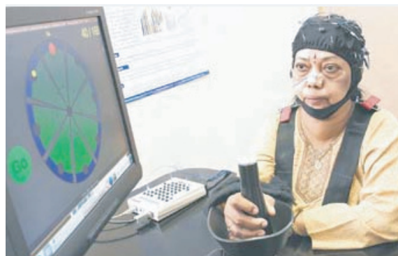
图7 使用运动想象脑机接口与机器人的反馈进行神经功能康复治疗(中风患者) [48]
