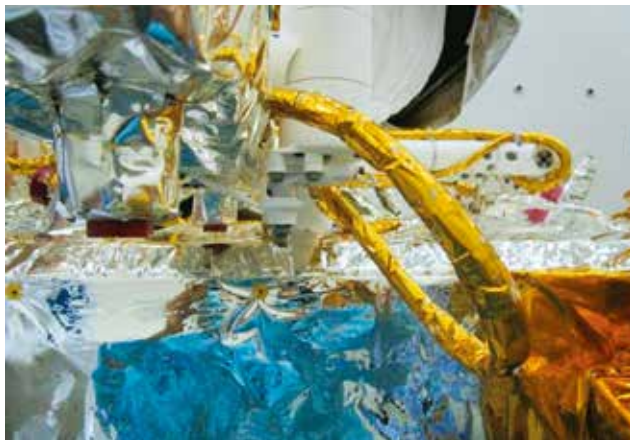
全景相机转台安装在着陆器上
