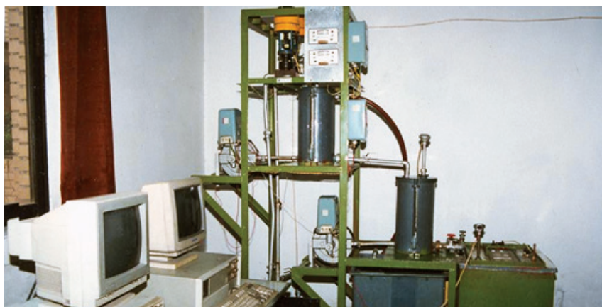
图5 冷热水混合器实验装置用作2-输入, 2-输出大系统的被控对象
