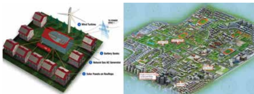
图9 建筑群多能源系统
